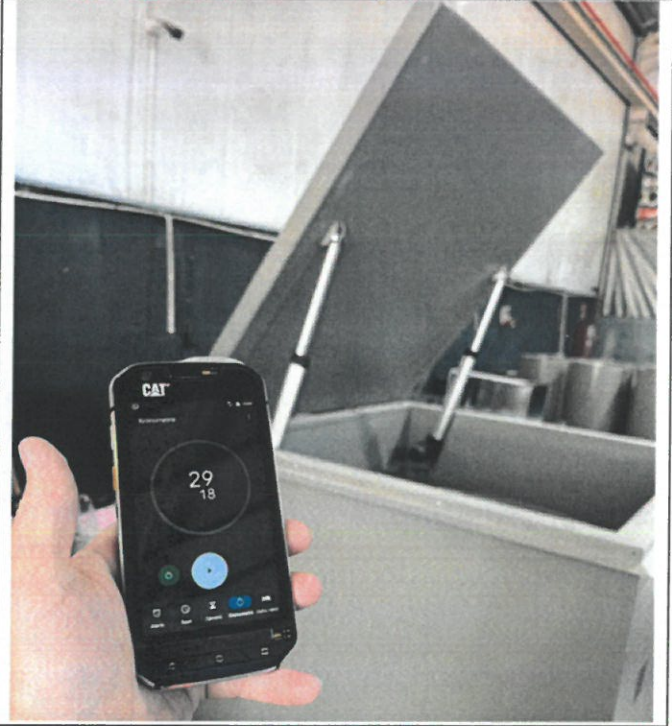
Foto No : 10 Kontrol Yeri : Novves – Çiftlikköy / Yalova Tanımlama : Kapak açılma süresi 29,18sn
