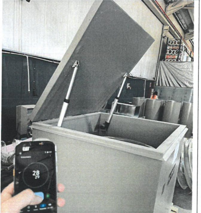
Foto No : 12 Kontrol Yeri : Novves – Çiftlikköy / Yalova Tanımlama : Kapak açılma süresi 28,29sn
